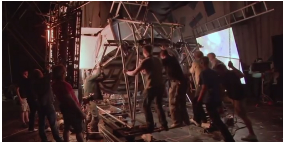
Fig. 34 - Sistema de agitação manual da cabine.
