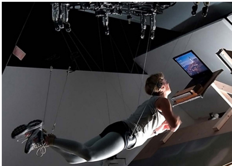
Fig. 31 - Sistema de arreios e servomotores.
