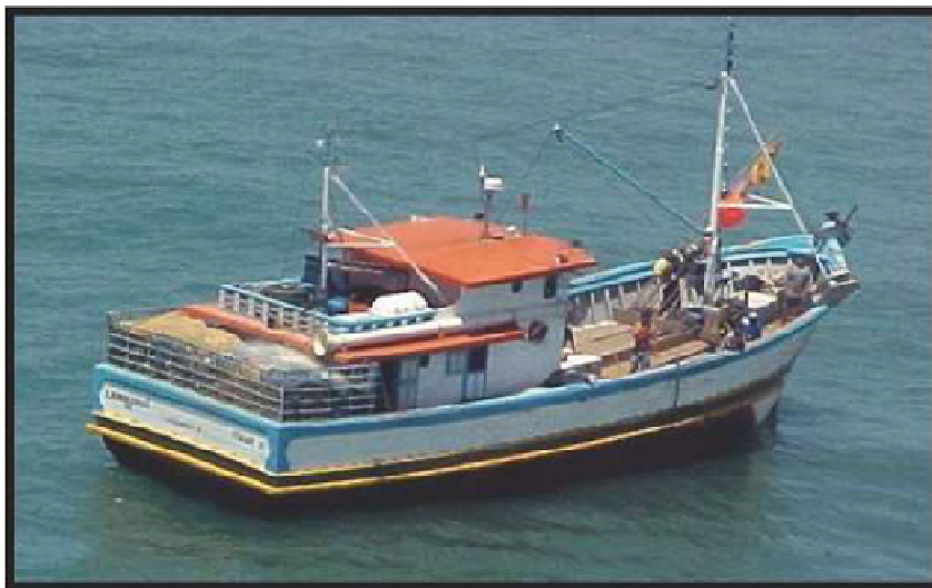
FIGURA 13 - EMBARCAÇÃO INDUSTRIAL DE EMALHE OCEÂNICO. NA POPA, O "CURRAL" ONDE ESTÃO ESTOCADAS AS REDES DE EMALHAR
