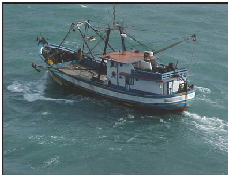
FIGURA 11 - EMBARCAÇÃO DE ARRASTO DUPLO (TANGONEIRO) EM OPERAÇÃO
