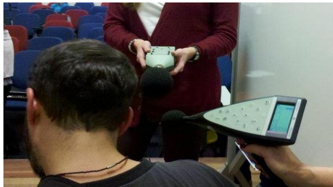
FIGURA 8 – MEDIÇÃO DOS NÍVEIS DE PRESSÃO SONORA DO BAIXO
